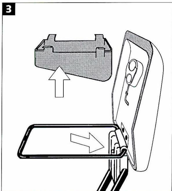
3 Individuelle Einstellung des Neigungswinkels mit beiliegendem Inbus-Schlüssel
