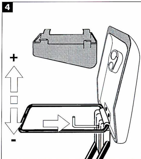
4 Drehen im Uhrzeigersinn = Heben
