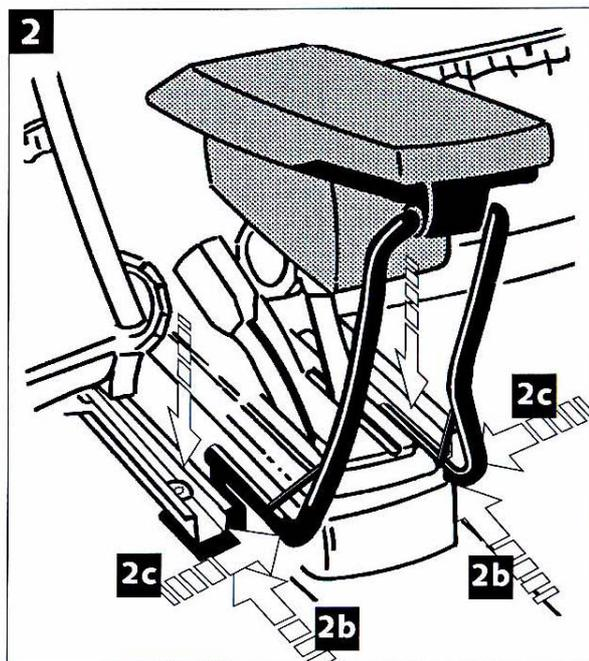
2 Bügel mit Flansch unter die Führungsschienen schieben,
